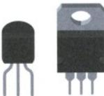
**Transistor** - Componente de tres terminales que puede trabajar como un interruptor electrónico. Es útil para controlar corrientes y tensiones grandes como la de los motores. Un terminal se conecta a masa, otro terminal a un elemento que se quiera controlar (motor, bombilla, zumbador) y el tercer terminal se conecta a una salida de
