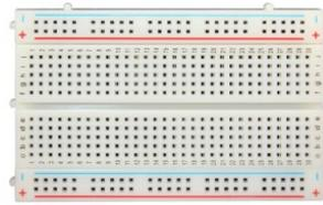
**Placa de pruebas** - Una placa sobre la cual puede montar componentes electrónicos. Es como un panel con agujeros, con filas de agujeros que le permite conectar juntos cables y componentes electrónicos. También están disponibles tarjetas sobre las que hay que soldar y también sin necesidad de usar un soldador como la mostrada aquí.
