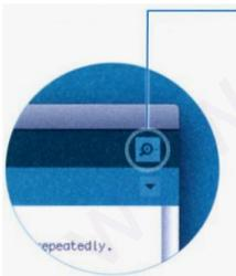
Una vez cargado el programa dentro de la tarjeta Arduino, hacer click sobre el icono del monitor serie. Debe de ver que aparece un listado de valores en el siguiente formato:
