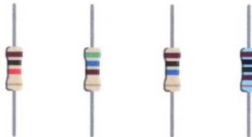
**Resistencias** - Se opone al paso de la corriente eléctrica en un circuito, dando como resultado a un cambio en la tensión y en dicha corriente. El valor de las resistencias se mide en ohmios (se representa por la letra griega omega:  $\Omega$ ). Las bandas de colores en un lado de la resistencia indica su valor (ver la tabla de código de colores de la resistencia en la página 41).
