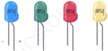
**Diodos Emisores de Luz (LEDs)** - Un tipo de diodo que emite luz cuando la corriente lo atraviesa. Como en todos los diodos, la corriente solo fluye en un sentido a través de estos componentes. Estará probablemente familiarizado con ellos al verlos como indicadores dentro de una gran variedad de dispositivos electrónicos. El ánodo, que normalmente se conecta al positivo de la alimentación, es generalmente el terminal más largo, y el cátodo el terminal más corto.
