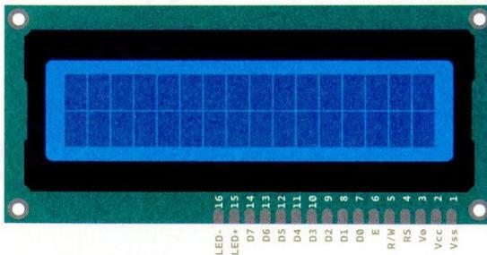
Todos los terminales de la pantalla LCD. No se conectan todos.
